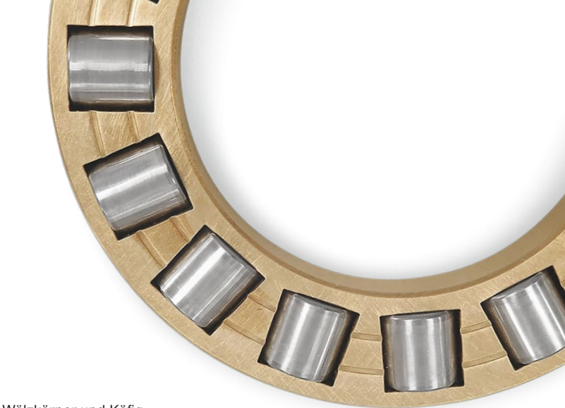
Wälzkörper und Käfig eines FAG FE 8 Lagers nach dem Prüflauf mit Berusynth GPX Getriebeöl
