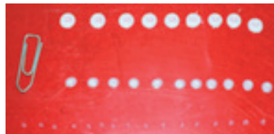
Beispiel: Aufschießen von Fett (von 0,0002g bis 0,5g/Schuss)
