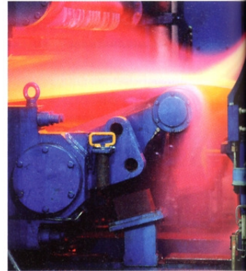
Wasser und Hitze: Höchste Anforderungen an Lager und Schmierstoff beim Warmwalzprozess
