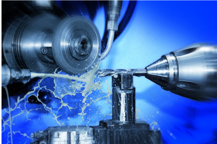
Schleifen eines Vollhartmetallbohrers mit BERUFLUID Foto: BECHEM
