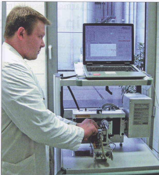
Durchführung von Prüfprogrammen für den Automotive-Kunden: Schwing-Reib-Verschleiß-Prüfstand Fotos: Bechem
